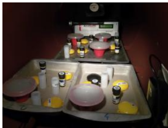
Rys.4. Wnętrze komory radonowej IFJ-600-KR z ekspozowanymi detektorami pasywnymi oraz z miernikiem AlphaGUARD PQ 2000PRO.
