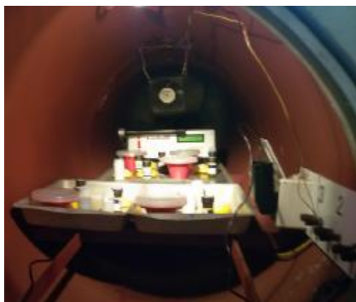
Rys.4. Wnętrze komory radonowej IFJ-600-KR z ekspozowanymi detektorami pasywnymi oraz z miernikiem AlphaGUARD PQ 2000PRO.
